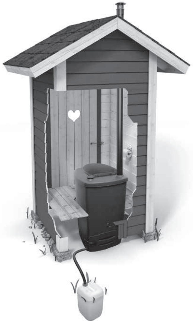
Attēls ar piemēru, kā uzstādīt sauso tualeti un novietot šķidrums novadišanas tvertni.
