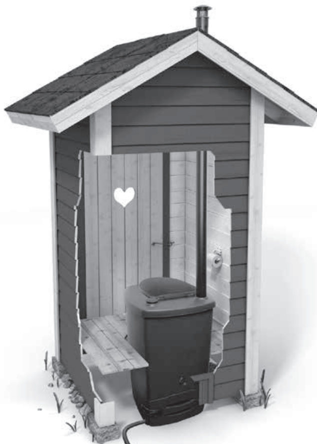
Skizze für die Toiletteninstallation und Aufstellung des Flüssigkeitskanisters
